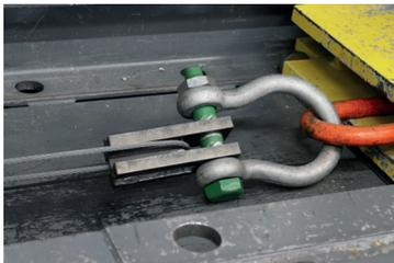
Umlenkung mit Stahladapter
