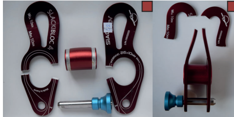
Abb. 5: Versagensbild statisch Slackibloc
