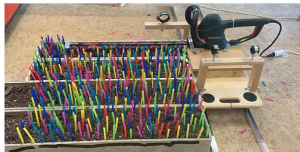
Abb. 2: Versuchsaufbau zur Ermittlung der Leistungsaufnahme bei der «Vegetation» Plastikstrohhalm
