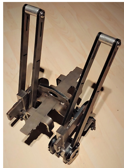
Abb. 2: Prototyp des mobilen Dachbefestigungspunktes
