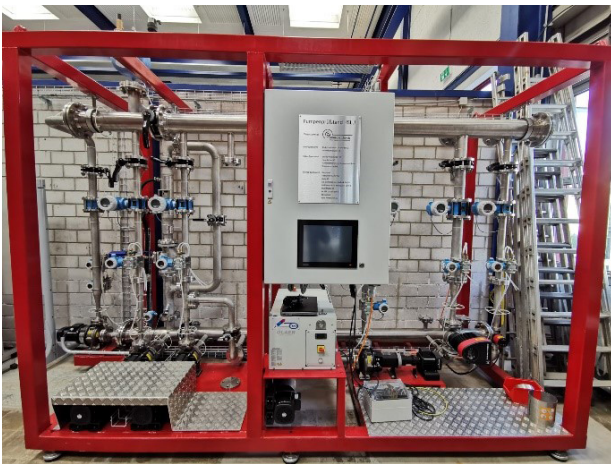
Abb. 1: Pumpenprüfstand im Labor
