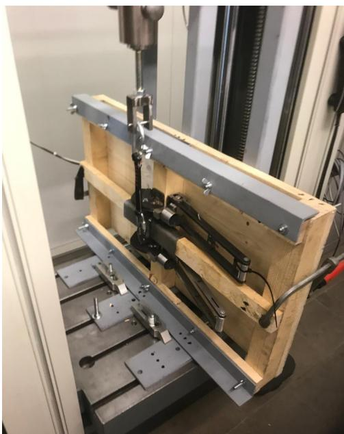
**Abb. 1:** Mobiler Dachbefestigungspunkt im Zugversuch
