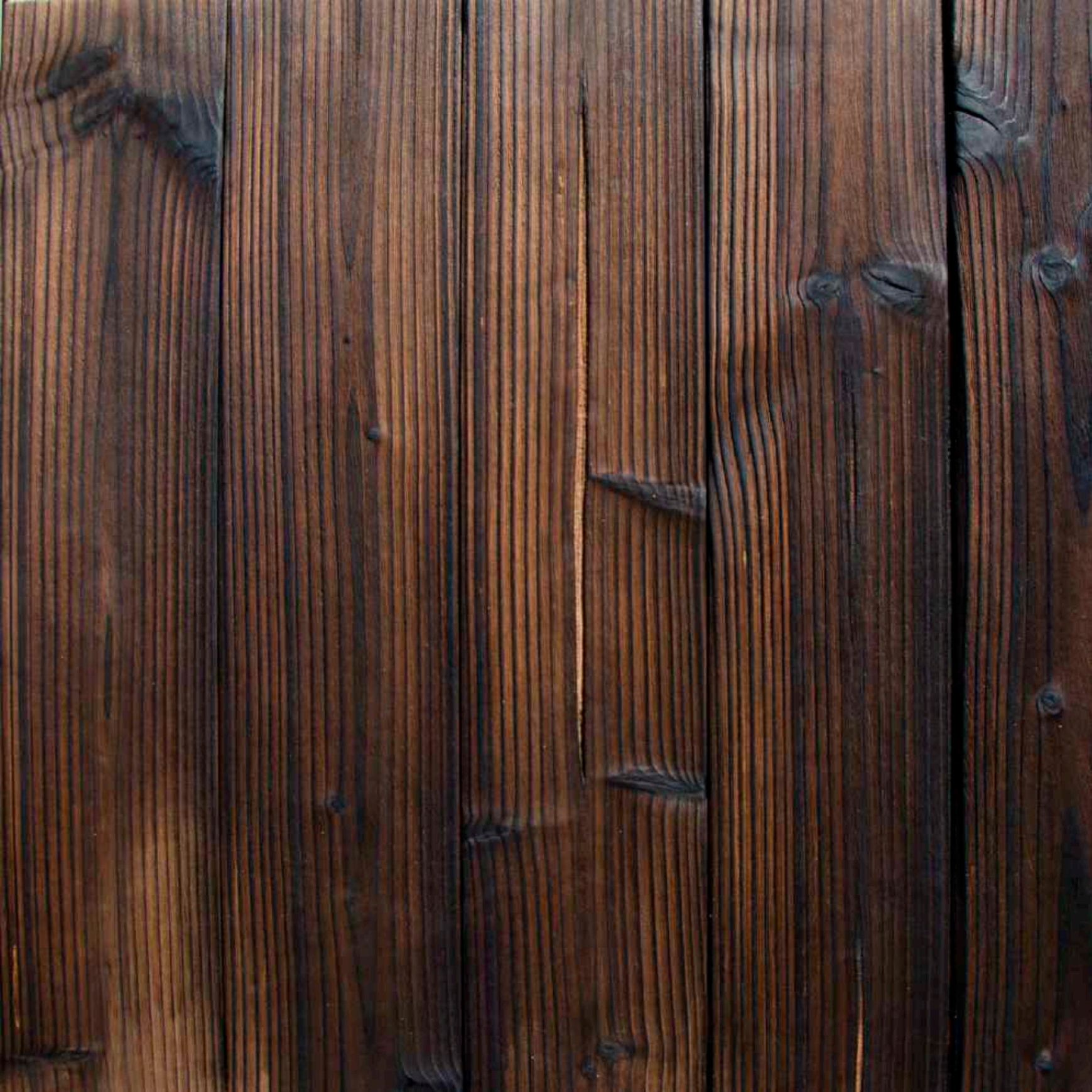
Abb. 4, 5 Testversuch nach Shou-Sugi-Ban
