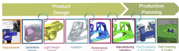
Abb. 1: NX-Prozesskette eines additiv gefertigten Bauteils (Quelle: Siemens PLM)
