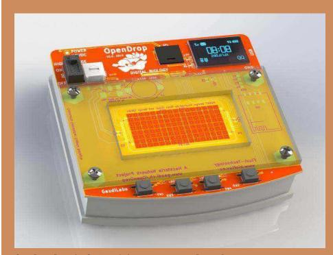
OpenDrop, Digtiales Gerät zur Laborautomatisation, Design Prototype
