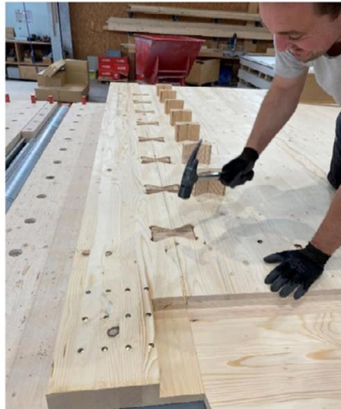
Abb. 5: Holz-Holz-Verbindungen mit gefrästen Nocken
