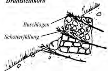
Terrassenartig eingebauter, durchgrünter Drahtsteinkorb
