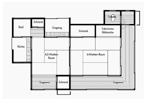
Abb. 14. Grundrissbeispiel des kleinen Gästewohnhauses am Shorinzan-Tempel in Takasaki. Um die beiden Wohnräume legt sich eine Schicht unterschiedlicher Funktionsbereiche.
