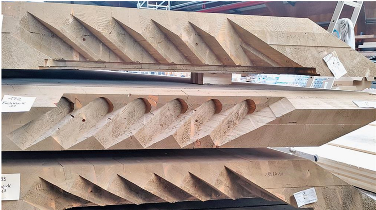
Abbildung 18: Gefräste Schubverbindung, © Derix-Gruppe
