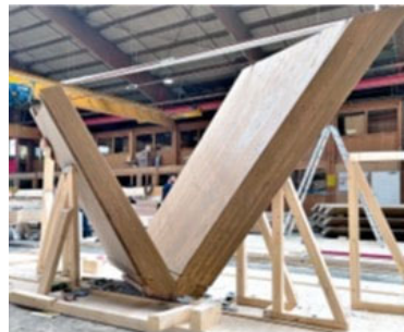
Abbildung 2: Mockup Fassadenstütze © Derix-Gruppe
