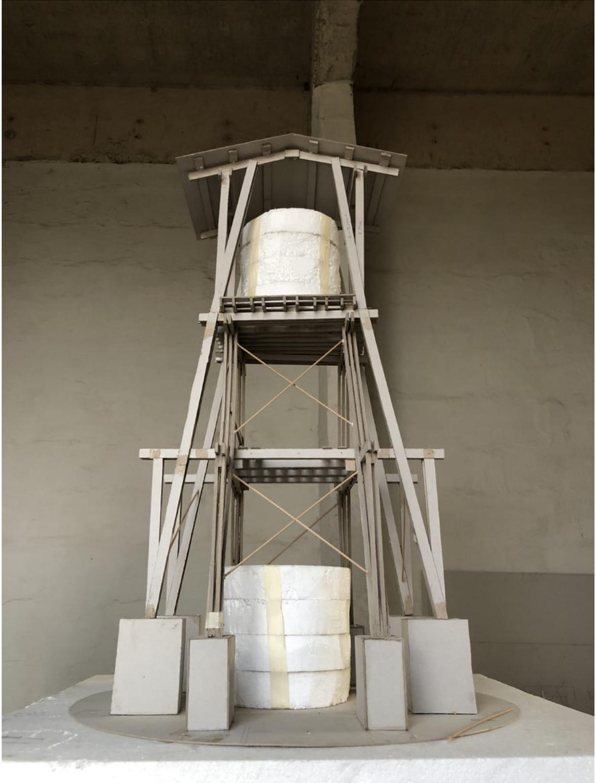
Abb. 14 – Model des Wasserturms mit den zwei 5'000 Liter Tanks.
