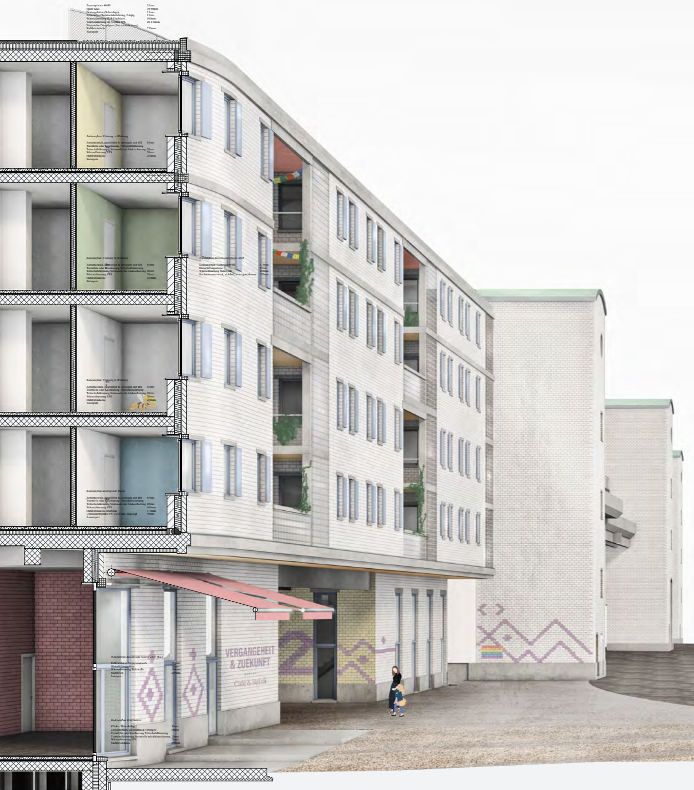
Abb. 86 Konstruktiver Fassadenschnitt und äusseres Erscheinungsbild Ostfassade Neubau
