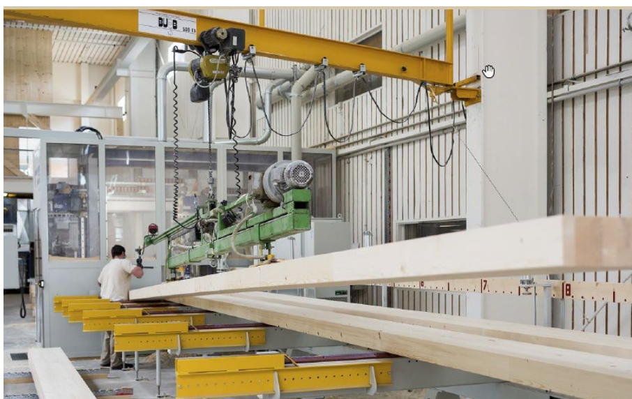
Abbildung 55: Abbundmaschine im Werk von schaeerholzbau. Quelle: schaeerholzbau
