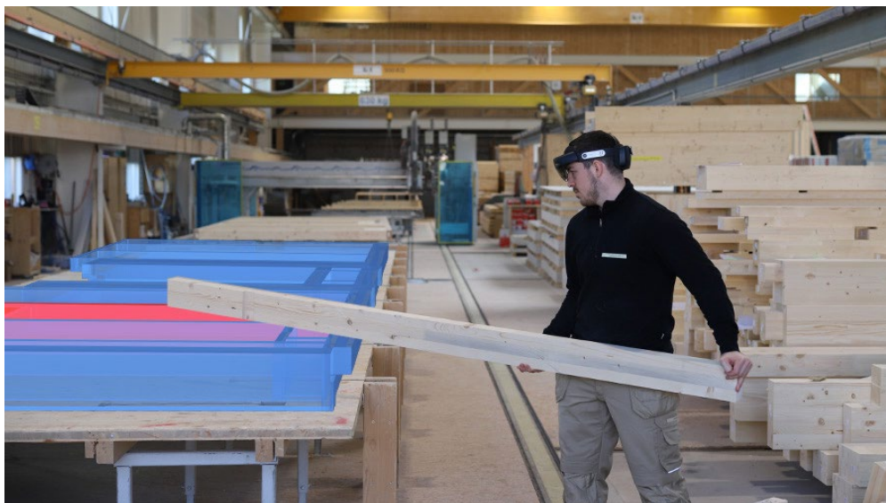
Abbildung 59: Montageunterstützung im Werk. Mittels HoloLens sieht der Zimmermann wie die Teile zu fügen sind. Quelle: schaerholzbau/afca
